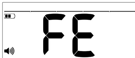
L'indicatore di volume sul display mostrerà il livello di volume corrente del ferro mentre sul display verrà visualizzato "FE".
