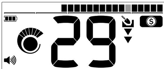
Quando viene rilevato un bersaglio, viene visualizzato un numero ID target. Questo esempio mostra il rilevamento di un quarto di dollaro poco profondo. Il segmento ID target corrispondente lampeggia al momento del rilevamento (in grigio).
